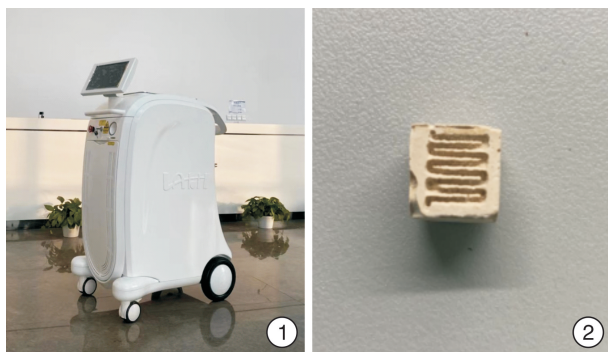
图 1 超脉冲钬激光机器; 图 2 人工结石在 SP-TFL 联合三维步进电机下激发后的形状
